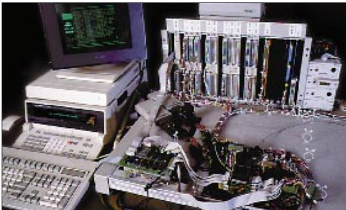
Computergesteuerter Funktionstest einer Baugruppe / Computer-controlled function test of a module
